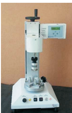
Motorisiertes Drehmomentprüfgerät Type "MOTOR-CAP" max. Messbereich: 10 Nm
