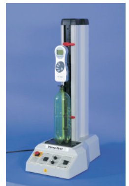
Top-Load Prüfsystem Type Multitest Kap.: 1; 2,5; 5; 10KN
